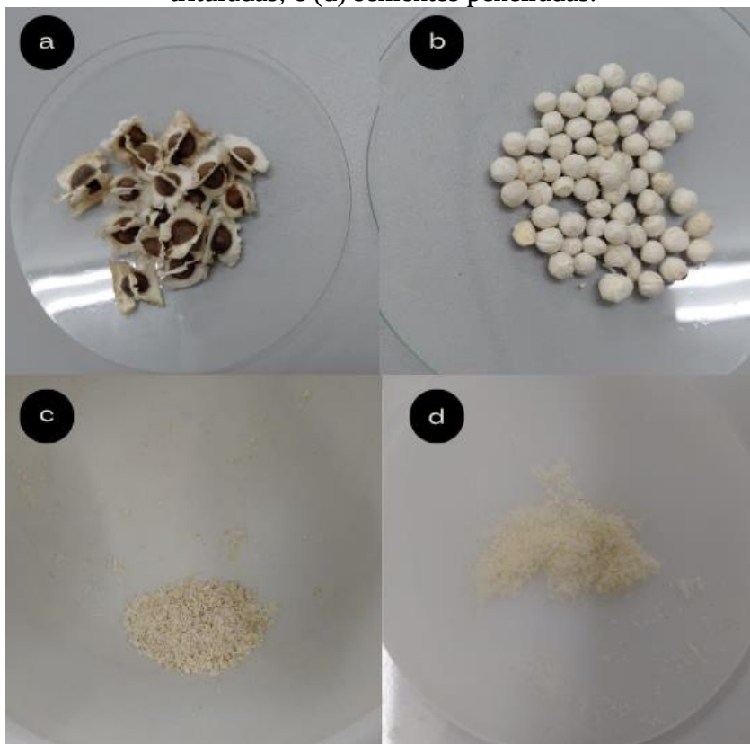
Figura 8 - Etapas de preparação das sementes de Moringa oleifera para obtenção do coagulante: (a) sementes in natura; (b) sementes após secagem e descascamento; (c) sementes trituradas; e (d) sementes peneiradas.
