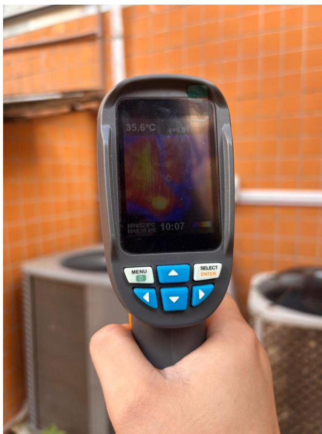
Figura 27 - câmera de imagem térmica manual HIT-02
