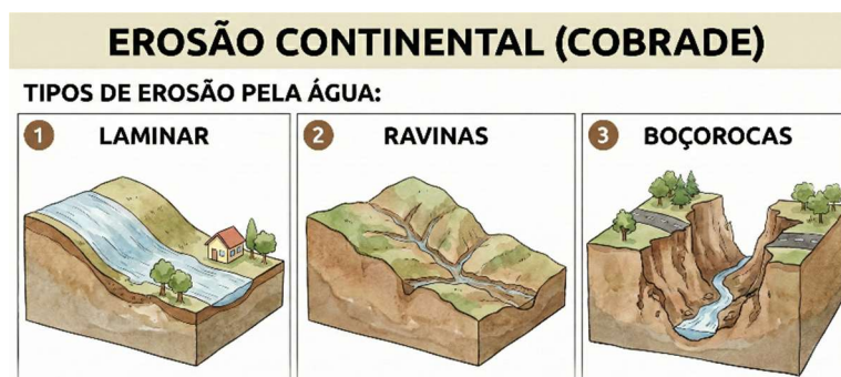
Figura 12 – Ilustração de erosão continental segundo a COBRADE
