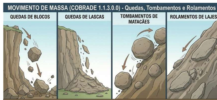
Figura 6 – Ilustração de movimento de massa do tipo quedas, tombamentos e rolamentos segundo a COBRADE
