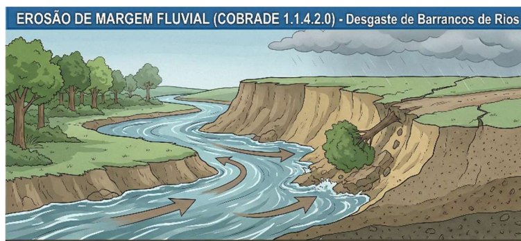
Figura 11 – Ilustração de erosão de margem fluvial segundo a COBRADE
