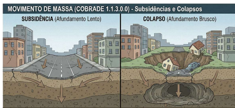
Figura 9 – Ilustração de movimento de massa do tipo subsidência e colapso segundo a COBRADE
