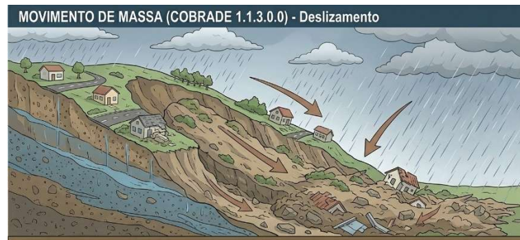
Figura 7 – Ilustração de movimento de massa do tipo deslizamento segundo a COBRADE
