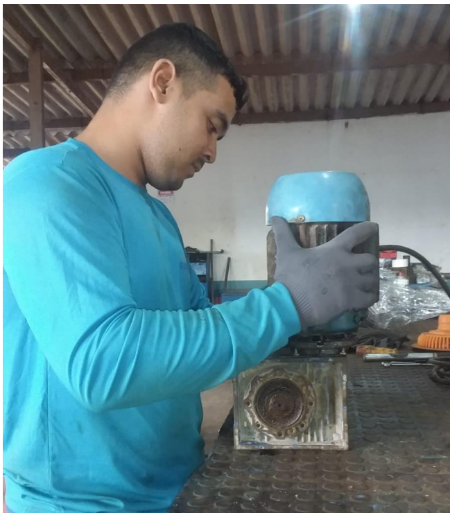
Figura 9. Acoplamento de Motor em Redutor.
