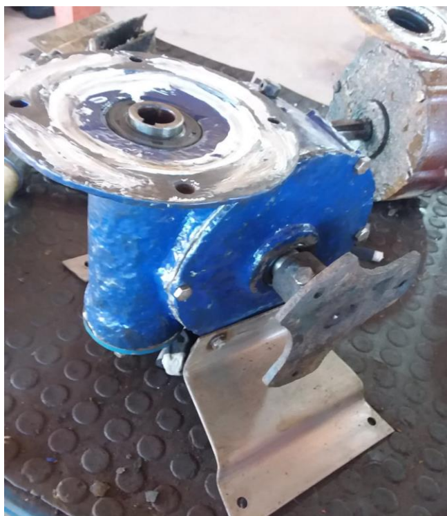
Figura 11. Redutor para Aeradores
