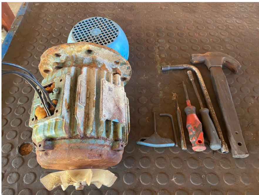
Figura 6. Ferramentas Utilizadas na Desmontagem do Motor.
