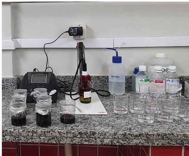
Figura 4: Determinação das curvas de Potenciais de Carga Zero (PCZ), das amostras de biocarvão.
