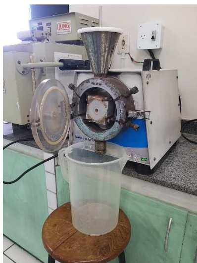
Figura 2: Moinho de Facas utilizado para triturar as cascas de coco verde.
