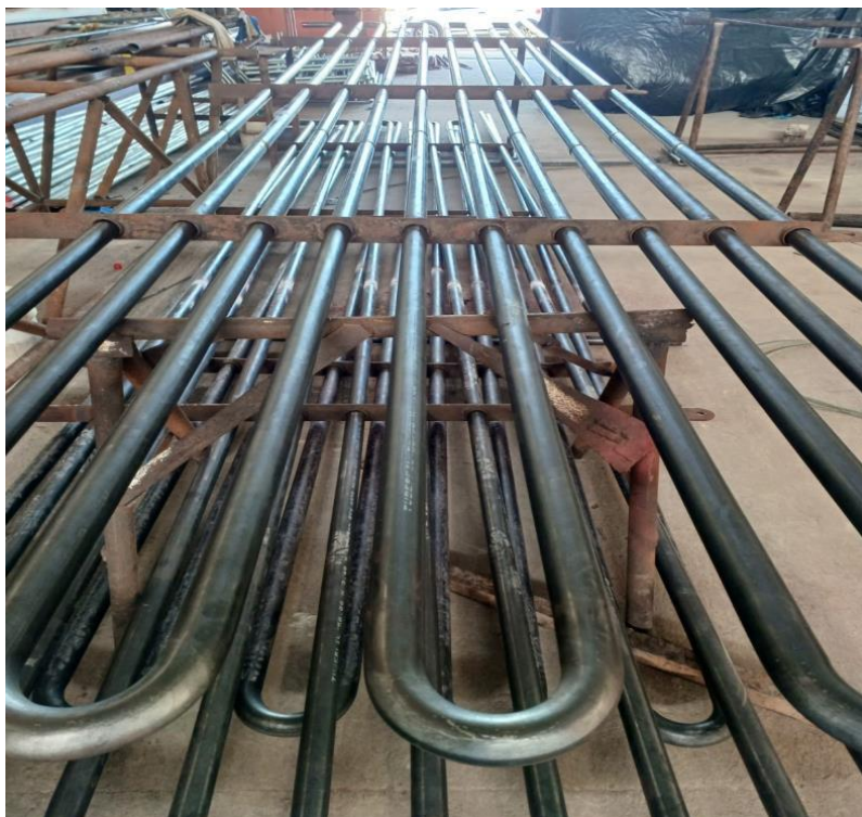
Figura 3 – Junção dos tubos para formação da serpentina
