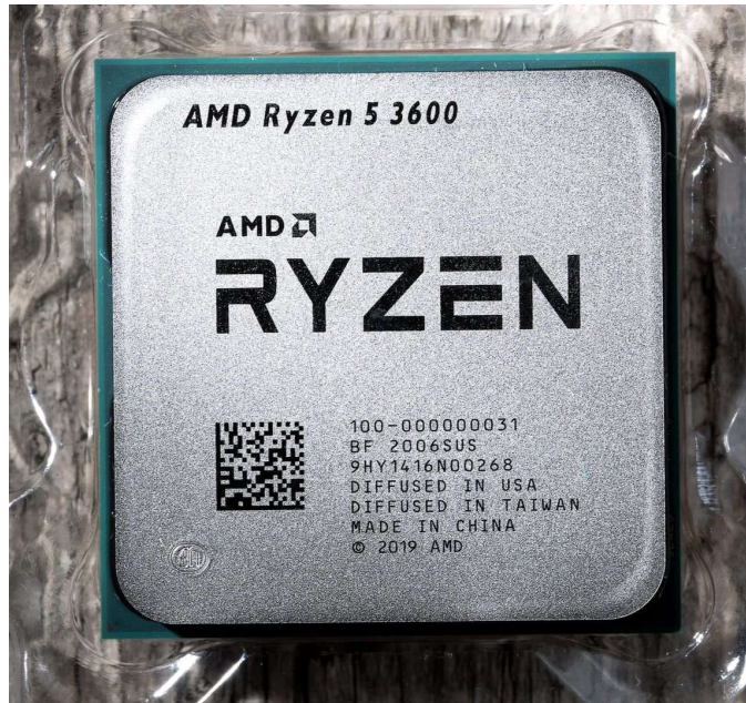
Figura 5 - Processador AMD Ryzen 5 3600
