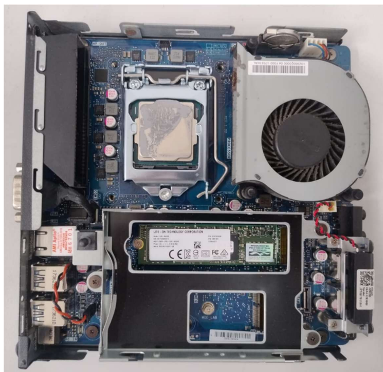
Figura 15 – Processador com a camada ressecada
