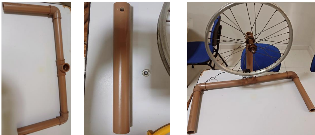
Figura 10 – canos para suporte e aro conectados.
