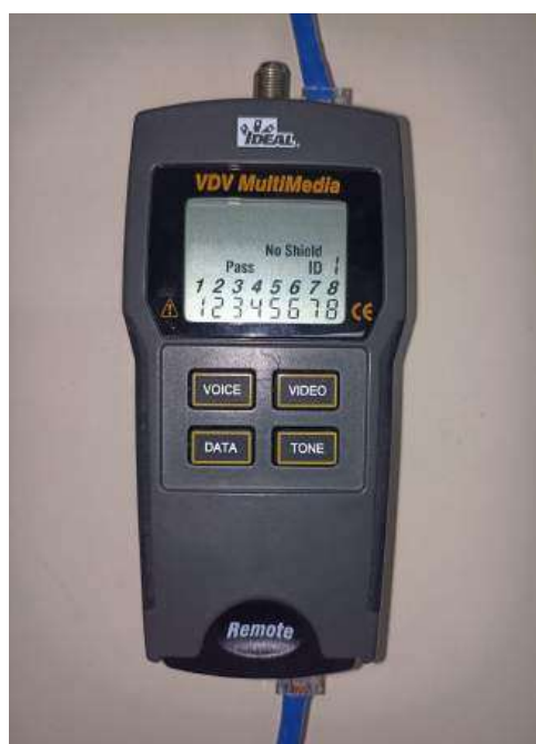
Figura 123 – Scanner para o teste do cabo
