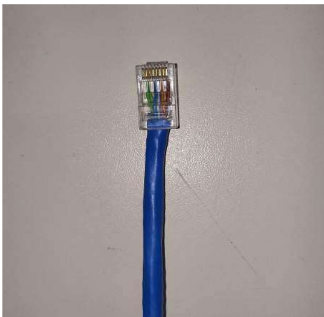
Figura 121 - Verificação do cabo antes de finalizar
