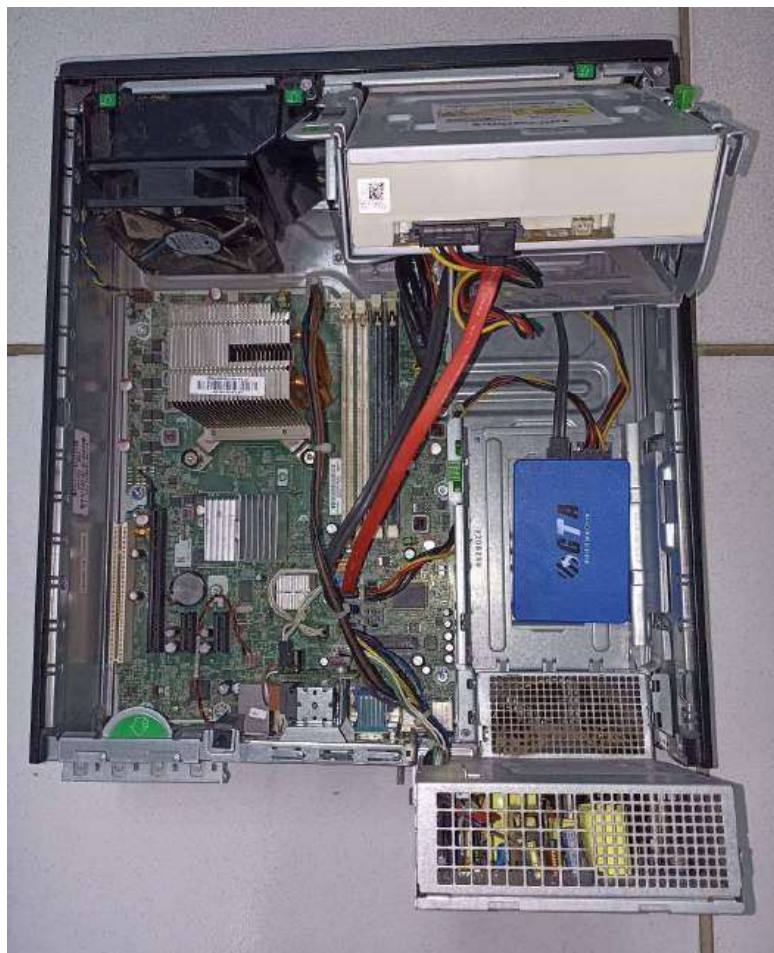
Figura 107 - Conexão do SSD no computador
