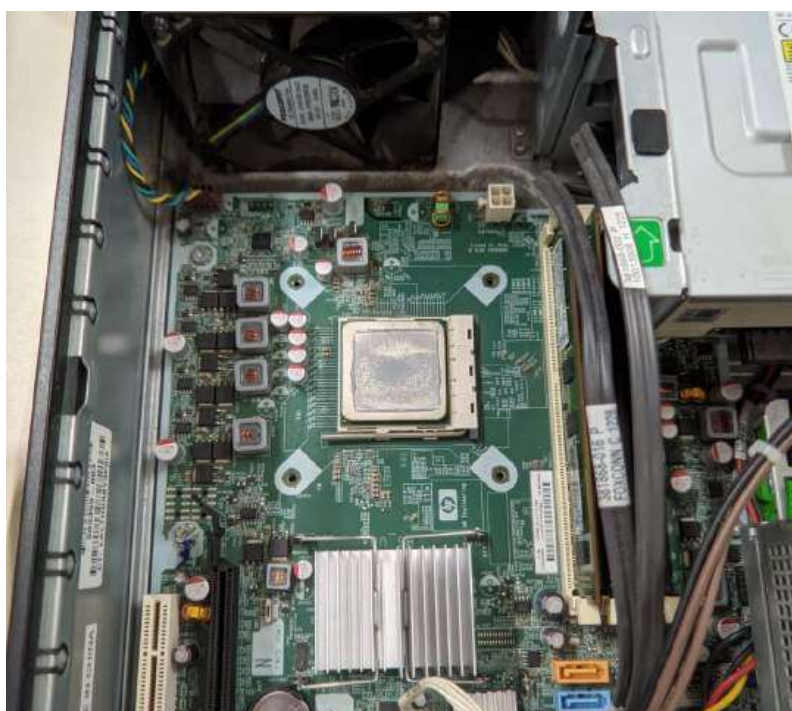
Figura 110 - Pasta térmica antiga no processador
