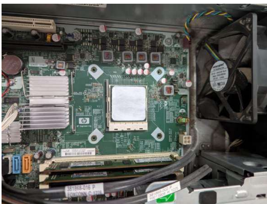
Figura 112 - Processador com a nova pasta térmica
