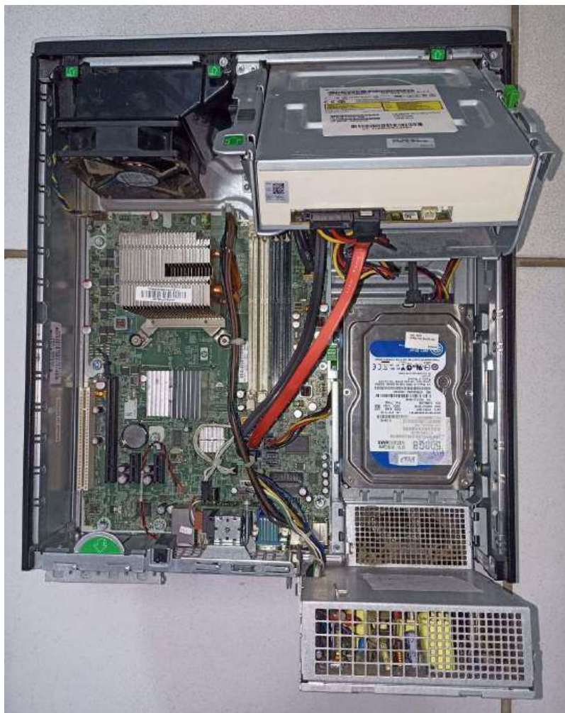
Figura 105 - Organização do gabinete para a retirada do HD
