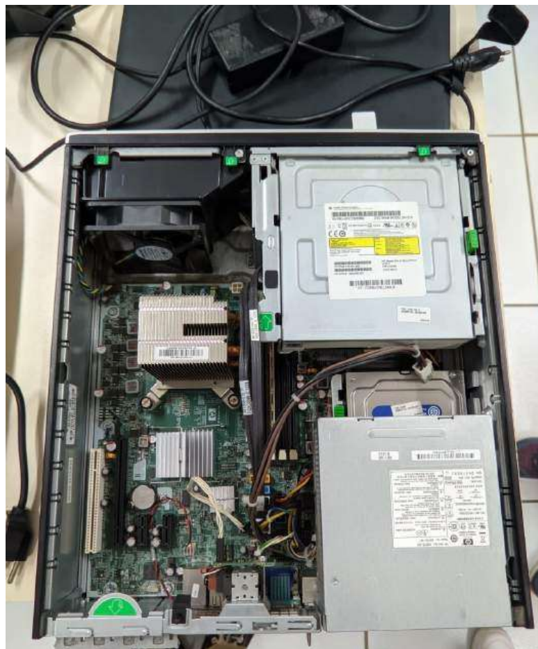
Figura 108 - Organização do cooler e processador
