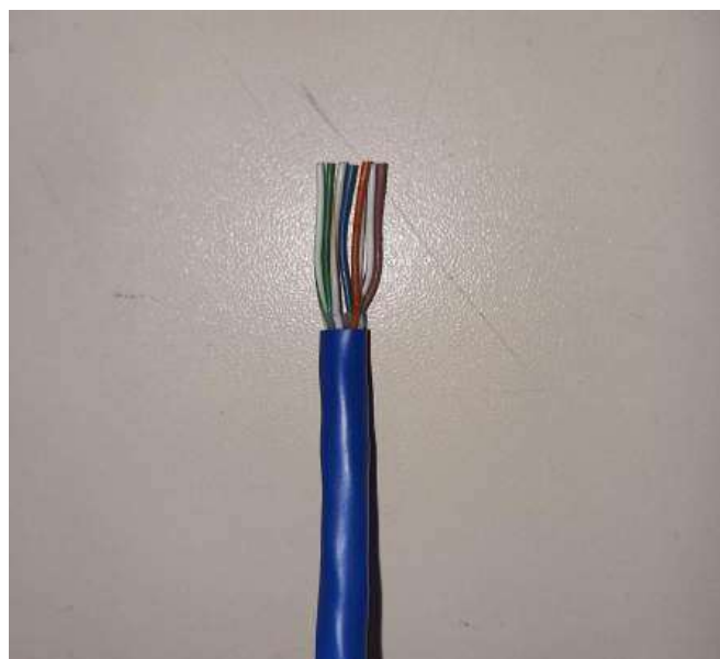
Figura 119 - Estrutura do cabo organizado no padrão "A"
