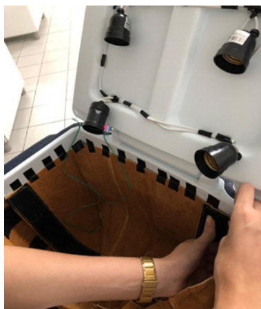
Figura 1 – tecido de couro (usado por soldadores) sendo fixado no cooler
