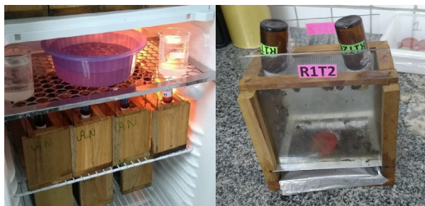
Figura 1 – (A) B.O.D com as gaiolas em confinamento. (B) Gaiola de madeira, com laterais de vidro e piso telado com alumínio, contendo também dois recipientes de água e xarope, além da alimentação sólida ofertada em tampa plástica vermelha no interior da gaiola
