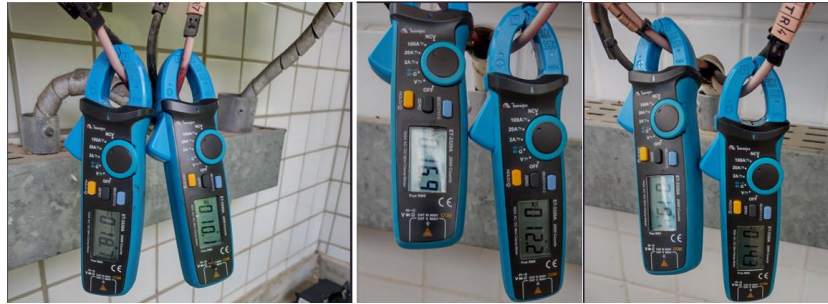
Figura 53 - Registros das correntes operacional nas entradas das MPPTS dos inversores ABB - campus de Mossoró
