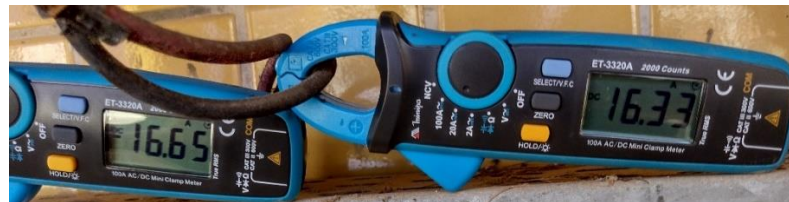
Figura 48 - Medição das correntes operacionais nas MPPT1 e MPPT2 na entrada do inversor ABB
