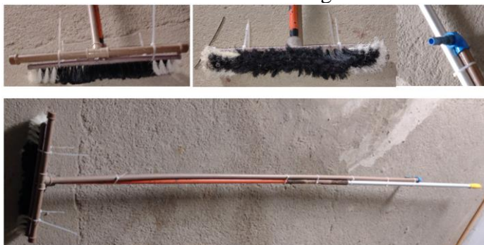
Figura 90 - Utensílio adaptado para realizar limpeza dos módulos fotovoltaicos do campus de São Paulo do Potengi
