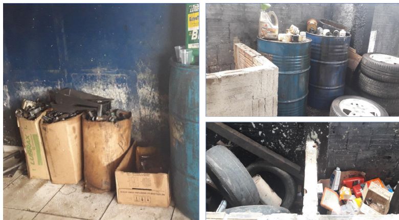
Figura 2 - Armazenamento de resíduos nas oficinas de Canguaretama/RN. Imagem da esquerda – Armazenamento de materiais ferrosos em caixas sem identificação. Imagem superior direita – Resíduos da oficina armazenados em ambiente exposto ao sol e a chuva. Imagem inferior direita – Resíduos da oficina expostos ao sol e a chuva.
