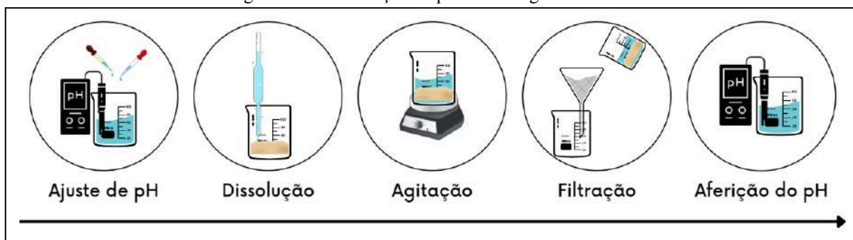
Figura 5- Determinação do ponto de carga zero da vermiculita
