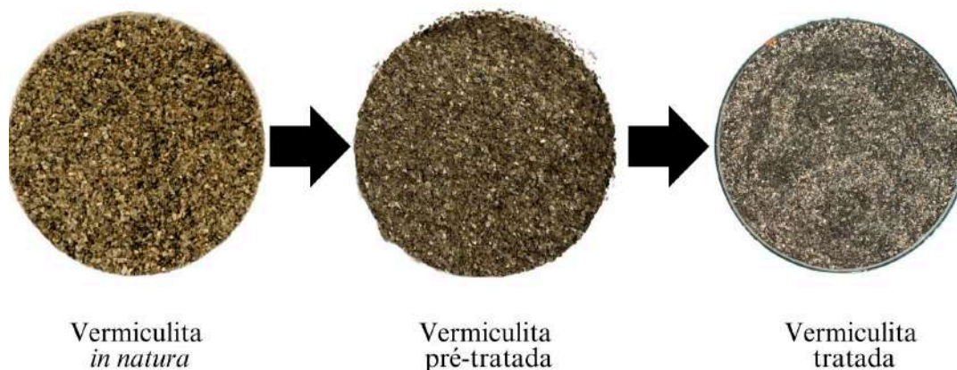
Figura 12 - Argila bruta submetida a pré tratamento e seguida de modificações iônicas
