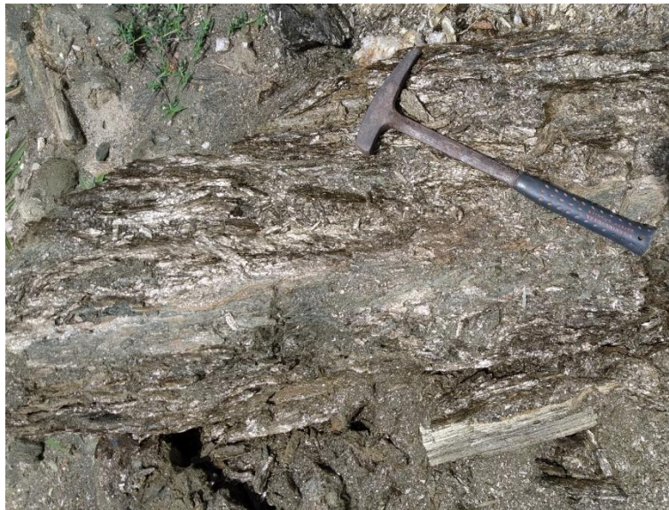
Figura 3- – Aspecto micáceo observado na Vermiculita Boqueirão, cor amarronzada e textura sedosa característica.
