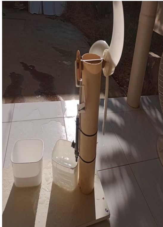
Figura 6 - Protótipo de cata-vento
