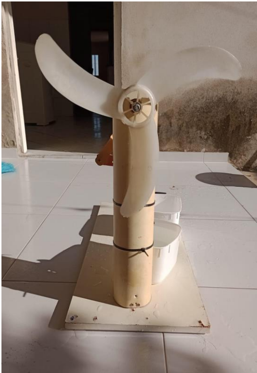
Figura 5 - Protótipo de cata-vento
