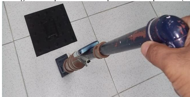
Figura 7 – Tag RFID implementada na superfície de um piso tátil (Figura 1).
