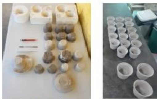
Figura 4 – Vasos produzidos via colagem de barbotina após etapa de queima a 900°C. em forno tipo mufla, e taxa de aquecimento de 5°C/min.
