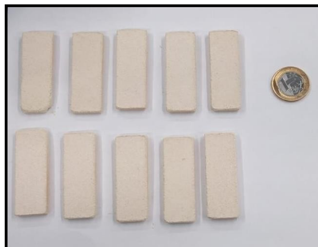
Figura 2 – Corpos de prova de argila branca sinterizados à 900°C.
