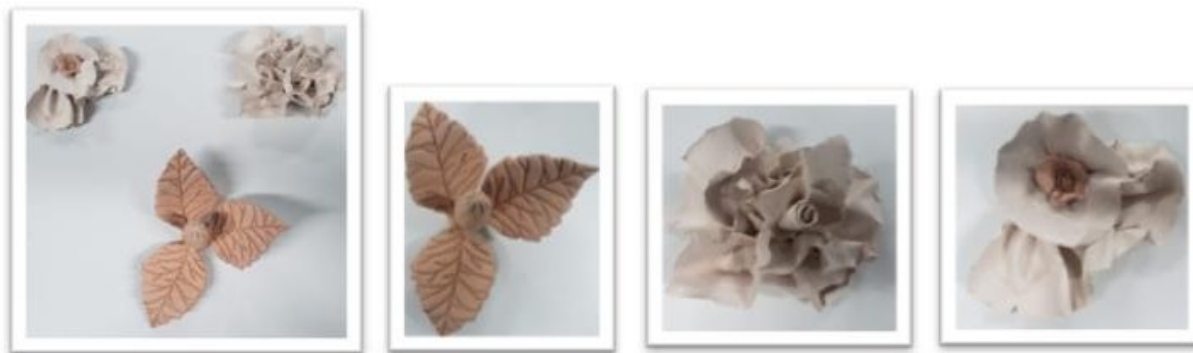
Figura 7 – Peças queimadas na temperatura de 850°C num forno tipo Mufla.
