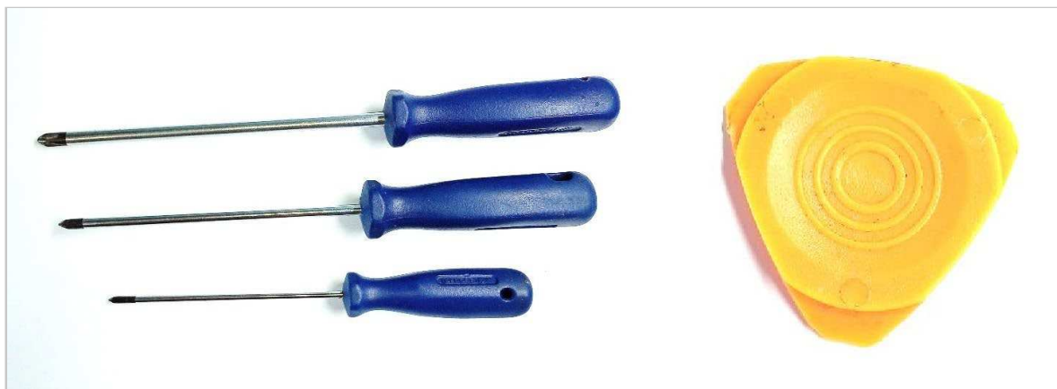
Figura 1: Parte do manual - Ferramentas para desmontar. Principais ferramentas utilizadas no desmonte de eletroeletrônicos. Fonte: Autor do Trabalho.
