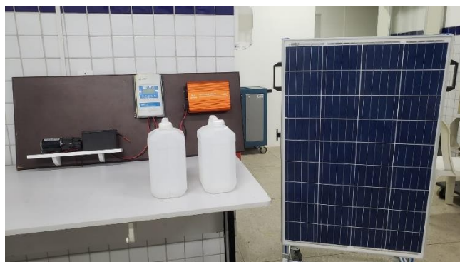
Fig. 2 - Protótipo do sistema de bombeamento de água com energia solar
