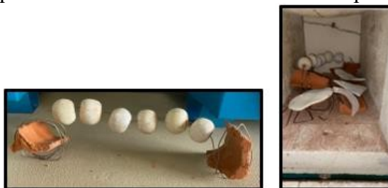
Figura 5 – Peças produzidas queimadas a 850°C com taxa de aquecimento de 5°C/min num forno tipo Mufla.
