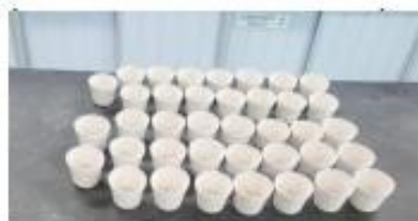
Figura 4 – Vasos produzidos via colagem de barbotina após etapa de queima a 900°C. em forno tipo mufla, e taxa de aquecimento de 5°C/min.
