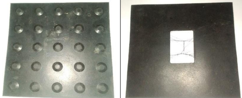
Figura 6 – Tag RFID implementada na superfície de um piso tátil.
