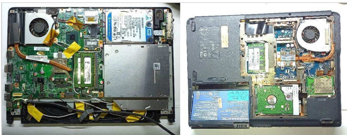
Figura 2: Componentes de notebook durante o processo de desmontagem. As figuras fazem parte do manual de desmonte de eletrônicos. Fonte: Autor do Trabalho.
