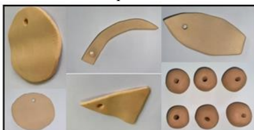
Figura 5 – Peças produzidas queimadas a 850°C com taxa de aquecimento de 5°C/min num forno tipo Mufla.
