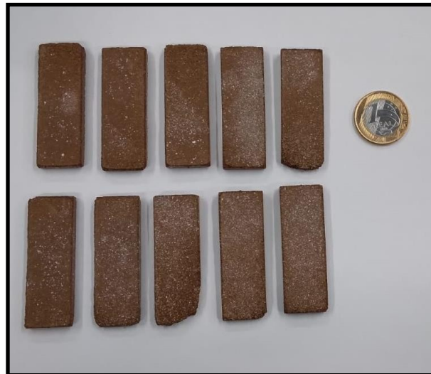
Figura 1 – Corpos de prova de argila vermelha sinterizados à 900°C.
