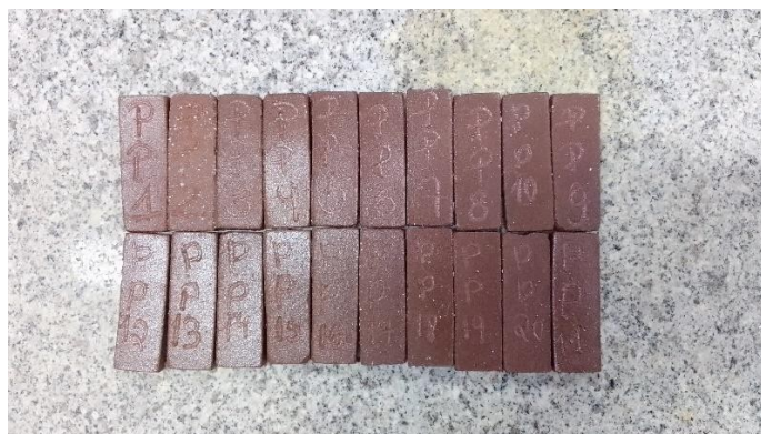
Imagem 1 e 2 – amostras com pegmatito antes da sinterização (acima) e após (abaixo).
