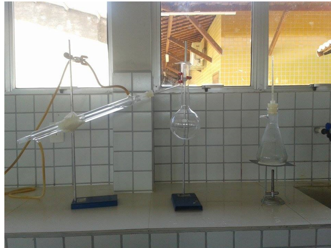
Figura I - Montagem da aparelhagem e preparação para extração.
