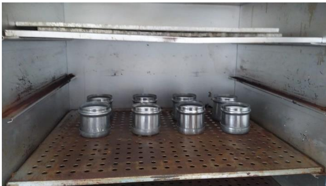
Figura 02. Determinação do grau de umidade em sementes de Libidibia ferrea pelo método da estufa.
