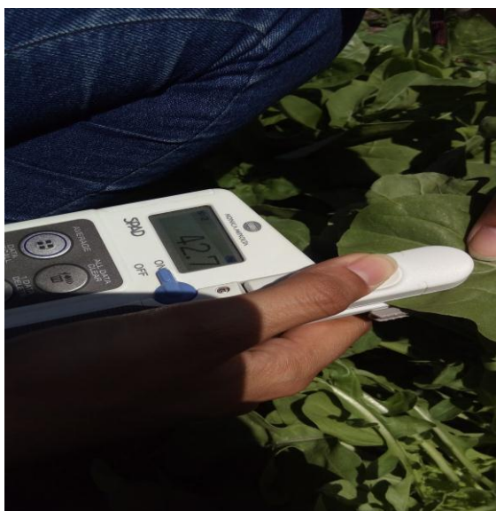
Figura 05: Medição de clorofila com SPAD-502 plus
