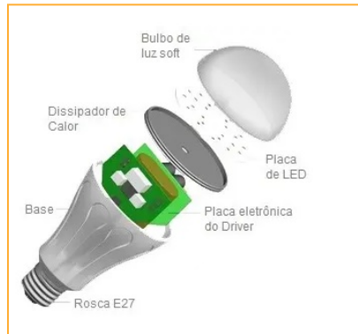
Figura 37 – Principais elementos das lâmpadas de LED.
