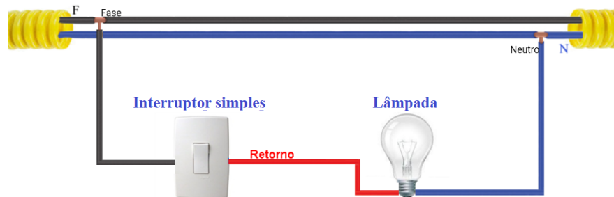
Figura 23 – Diagrama multifilar do comando de uma lâmpada por um interruptor simples.
