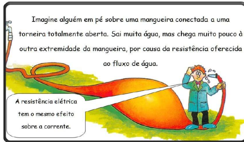
Figura 14 – Analogia comportamento resistência elétrica com hidráulica.
