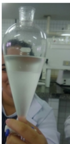
Figura 4 - Lavagem do Solketal para Remoção do Catalisador . Fonte: Autoria Própria.
