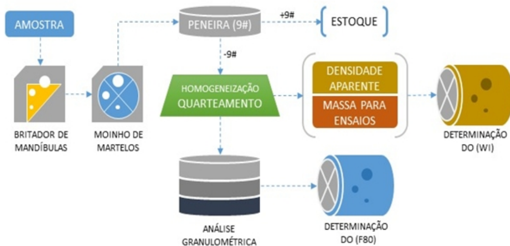
Figura 2 - Apresenta o fluxograma simplificado do processo para a determinação do WI. Fonte: AUTORES.
