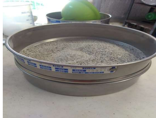
Fotografia 2 – Peneiramento do rejeito da Scheelita
