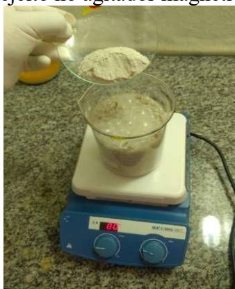
Fotografia 3 – Rejeito no agitador magnético para lixiviação
