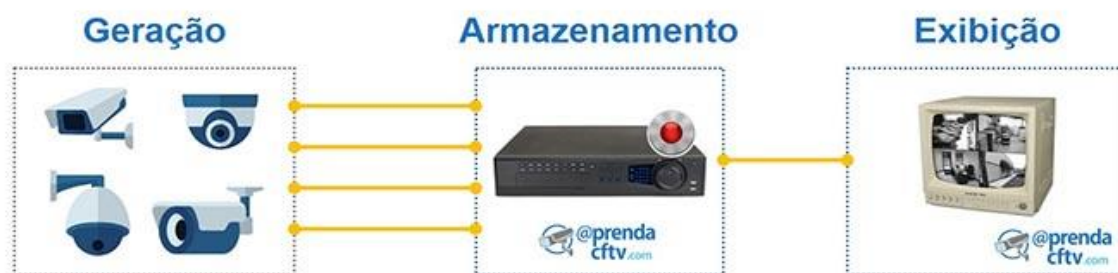
Figura 01 - Câmeras que irão gerar as imagens, o gravador ao centro e finalmente um monitor que irá exibir as imagens provenientes das câmeras ou do gravador.
