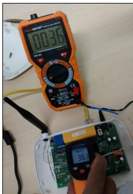
Foto 5: Temperatura máxima durante a transferência
