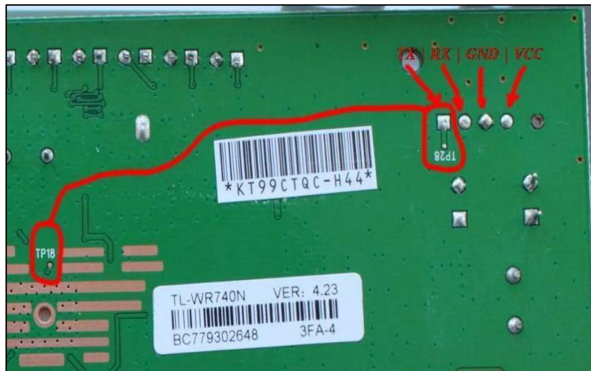
Figura 17: Exemplo do processo de solda na placa do roteador
