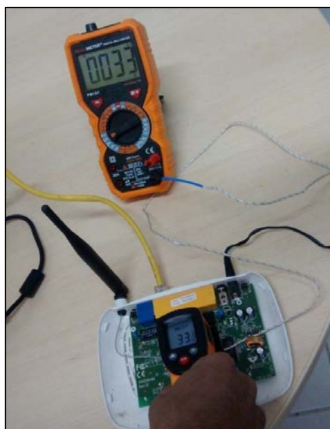
Foto 6: temperatura máxima estável sem utilização (OpenWrt).
