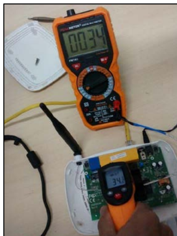
Foto 4: temperatura máxima ao atingir estabilidade sem utilização.
