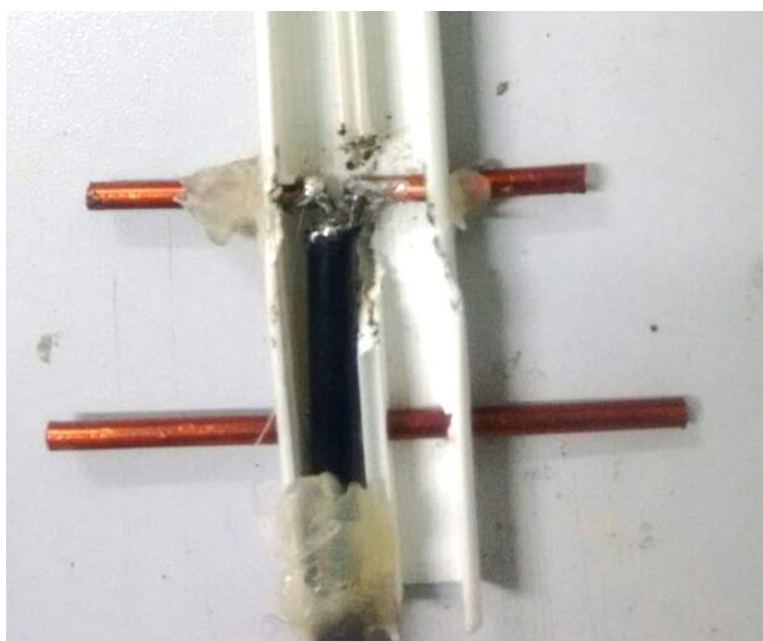
Figura 48 - Dipolo soldado ao cabo coaxial.
