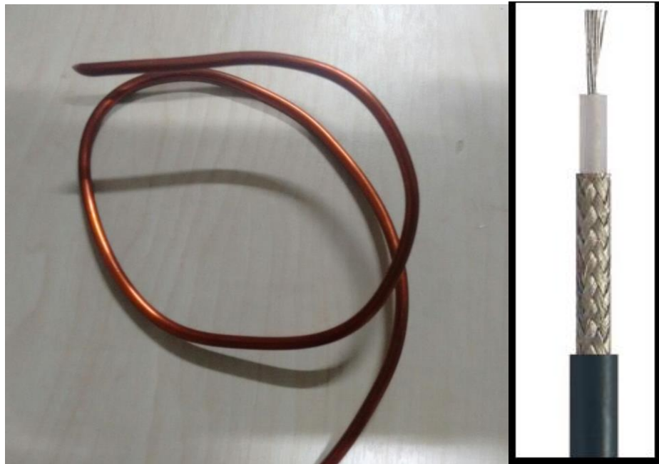
Figura 44 - Fio de cobre(a) com 3 mm e cabo coaxial(b)
