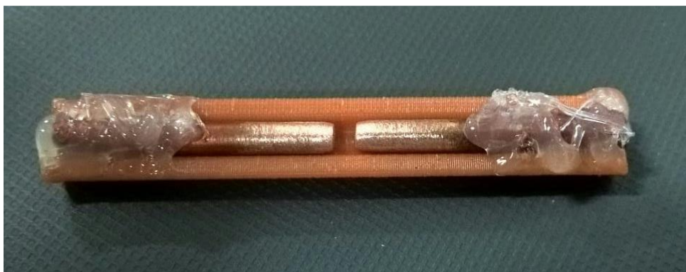
Figura 51 - Elementos lixados para soldagem do cabo coaxial.
