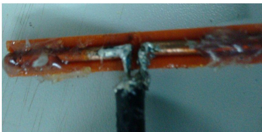
Figura 52 - Antena dipolo soldada ao cabo coaxial.
