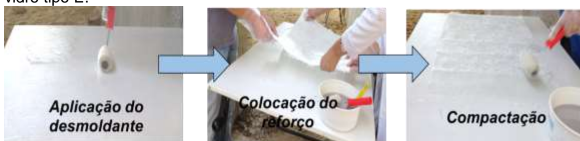
Figura 19 - Processo de fabricação do compósito polimérico reforçado com fibra de vidro tipo E.
