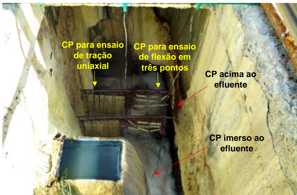
Figura 22 - Exposição dos CP de PRFV.
