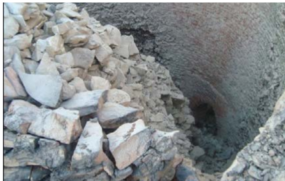
Figura 21: Forno Utilizado na Queima de Calcário para a Produção de Cal.
