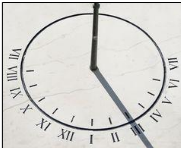
Figura 15 - Relógio solar - Dispositivo simples que serve para medir o ângulo horário do Sol por meio da sua projeção.
