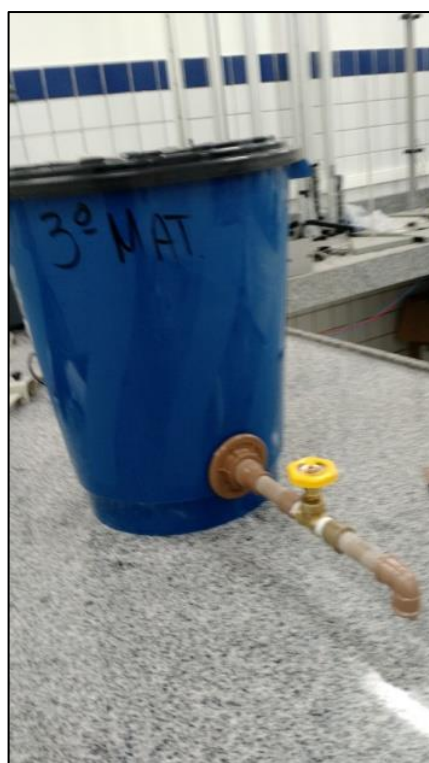
Figura 21: Sistema de Caixa d'água artesanal. Fonte: Autor
