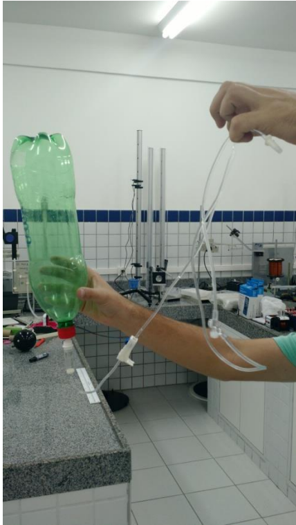
Figura 14: Sistema de Irrigação localizada construído com EQUIPO. Fonte: Autor
