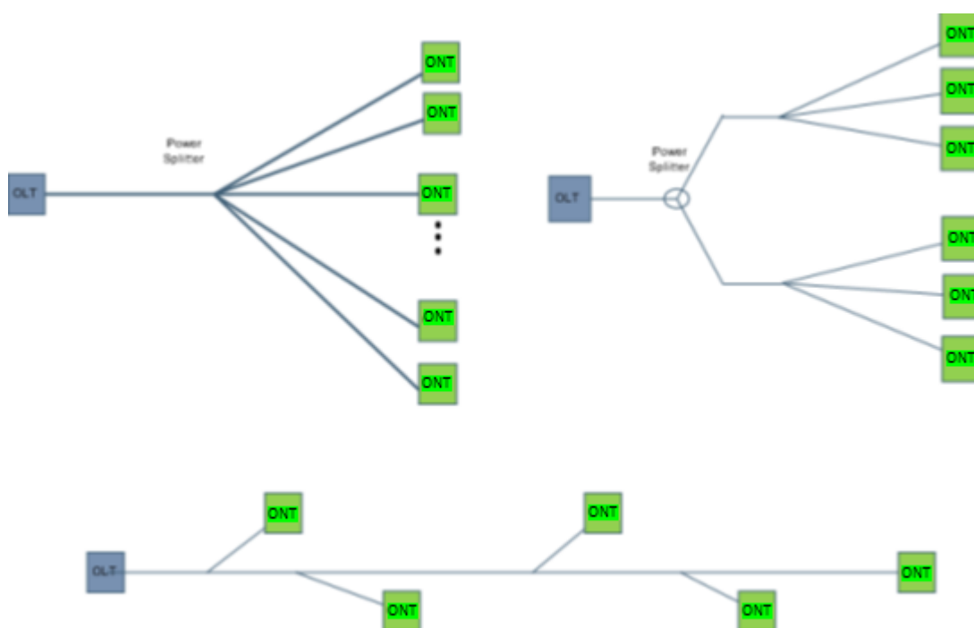
Figura 7 – Topologias de repartição do sinal óptico
