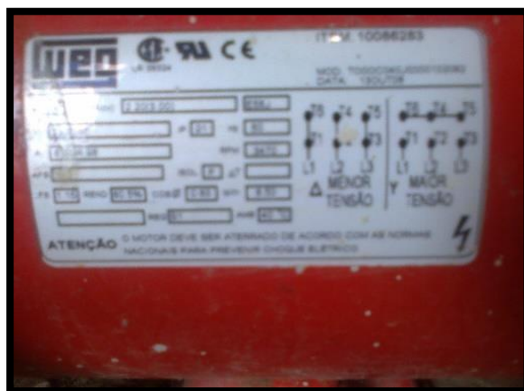
Figura 14- Bomba Centrífuga 3CV trifásica para incêndios.
