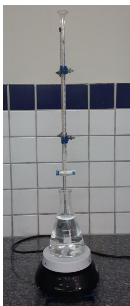
Figura 3 – Análise de residual de dióxido de cloro, pelo método iodométrico.
