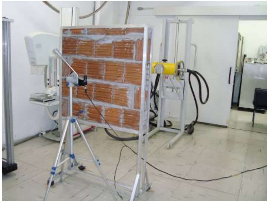
Figura 4.13: Arranjo experimental utilizado para a determinação das propriedades de atenuação dos blocos cerâmicos.
