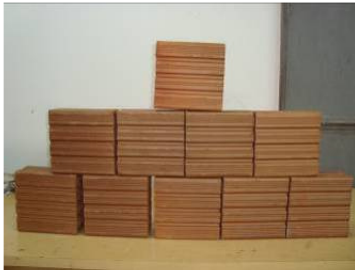
Figura 5.12: Fotografia dos blocos cerâmicos extrudados e queimados na temperatura de 950 °C.
