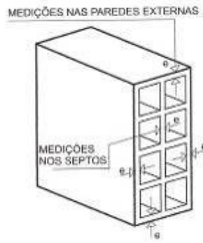
Figura 4.8: Posições esquemáticas para as medições da espessura das paredes externas e septos.
