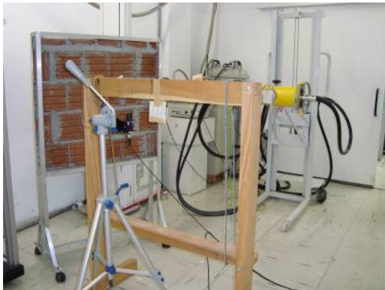
Figura 4.15: Arranjo experimental da equivalência em chumbo montado no Laboratório do IEE/USP, utilizado para a determinação das propriedades de atenuação dos blocos cerâmicos.
