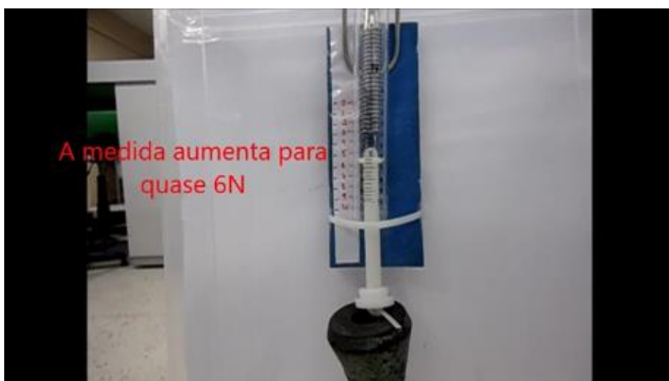
Figura 17. Vídeo 5 – Dinamômetro subindo com contrapeso de 2 kg.
