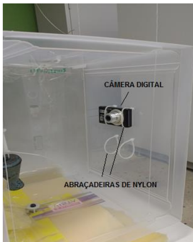
Figura 6 Detalhes da fixação da câmera digital.
