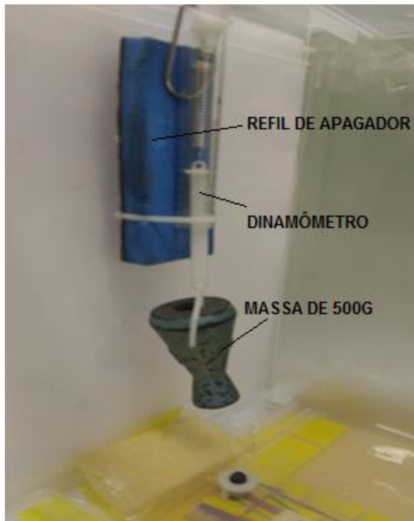
Figura 7 Detalhes da fixação do dinamômetro
