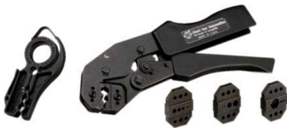
Figura 2: Descascadores de cabos coaxiais (à esquerda) e alicate de crimpagem
