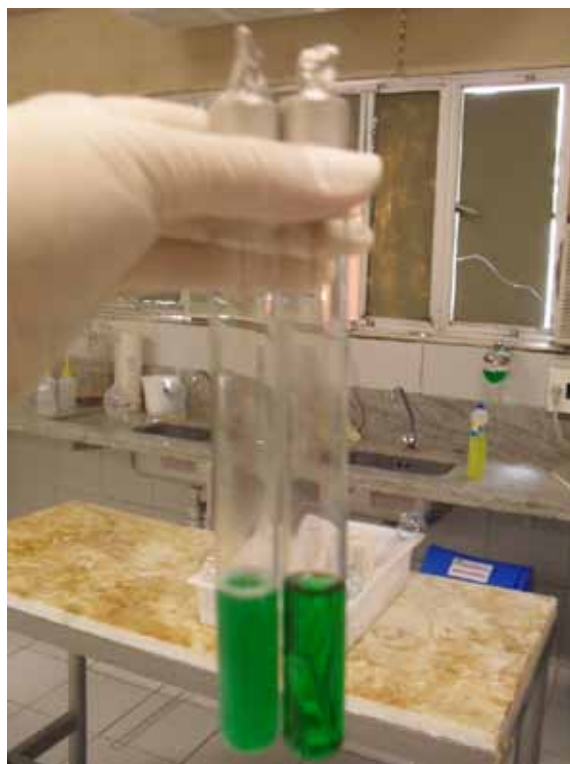
Figura 2 – Amostra com resultado positivo para coliformes totais à esquerda e amostra com resultado negativo à direita
