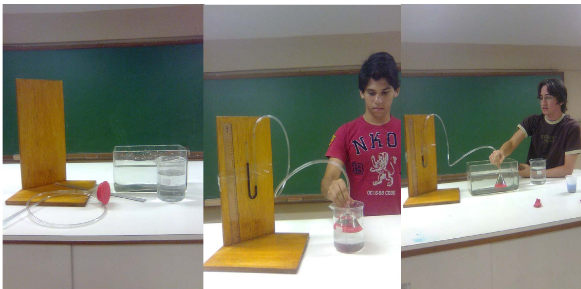
Figura 2. (a) Componentes do manômetro; (b) Manômetro montado; (c) Variação da pressão em recipiente diferente
