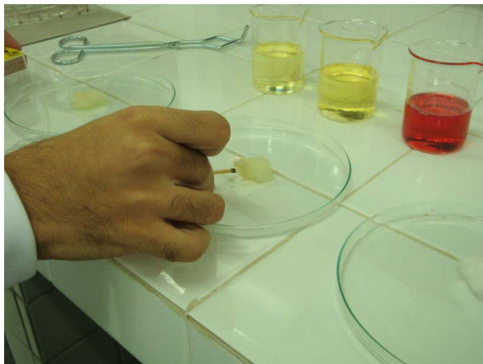
Figura 4 – Teste de Combustão do óleo de soja, biodiesel e diesel de petróleo respectivamente
