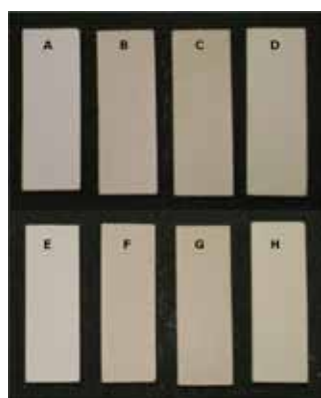
Figura 2 – Sinterização à 1050°C.
