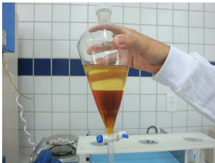
Figura 3 – Separação das fases do produto da reação da transesterificação
