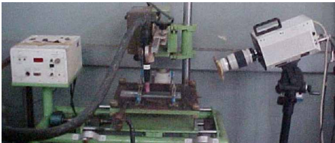
Figura 1 : Bancada experimental montada para adquirir imagens do arco.
