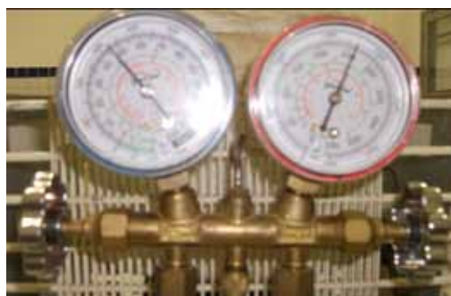
Figura 2 - Conjunto de manômetros (manifold).
