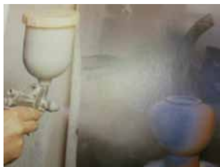
Figura 5- Aplicação por Pulverização (CHAVARRIA,2004)
