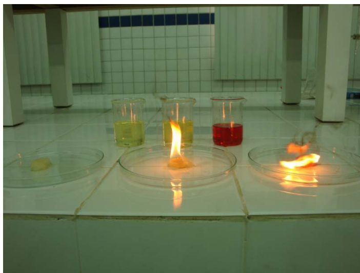
Figura 5 – Combustão de algodão umedecido em óleo de soja, biodiesel e diesel de petróleo.
