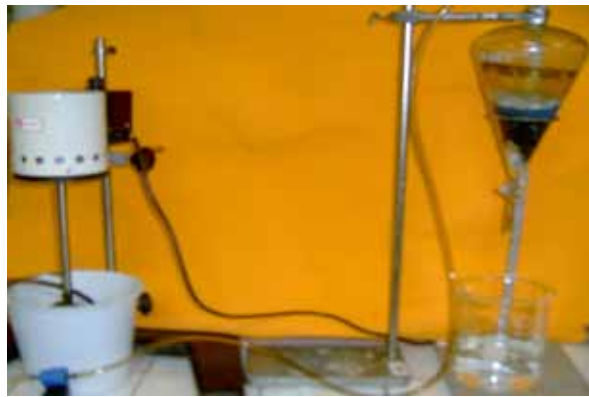
Figura 03 – Esquema do funil de separação com o carvão ativado
