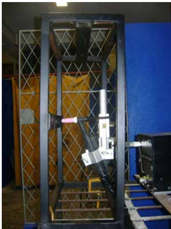
Figura 1. Dispositivo para soldagem fora da posição plana, com a tocha do processo TIG na posição horizontal.
