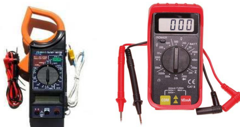
Figura 2 – Da esquerda para a direita, um alicate amperímetro e um multímetro, equipamentos de medição elétrica.
