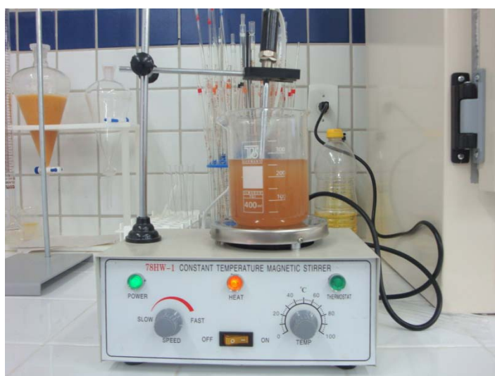
Figura 2 – Transesterificação metílica do óleo de soja
