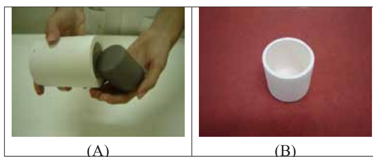
Figura 4. (A) – Desmoldagem da peça e (B) – Peça pré-sinterizada.
