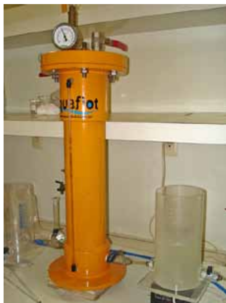
Figura 2- Célula de flotação em escala de bancada.
