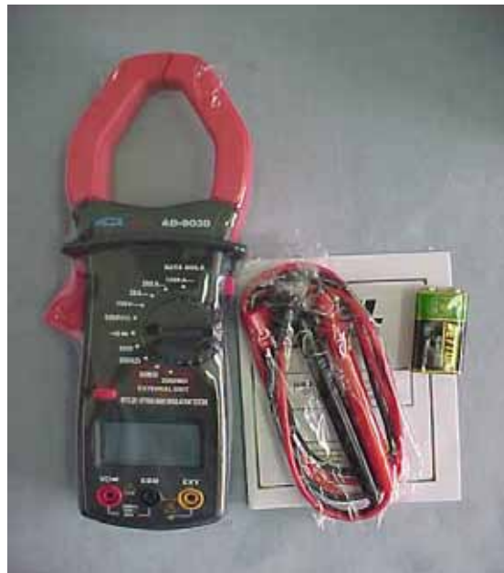
Figura 5 – Alicate amperímetro utilizado no ensaio.
