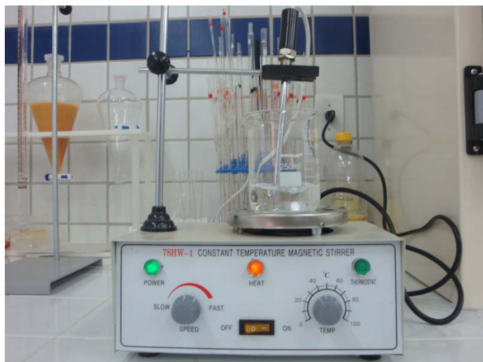
Figura 1 – Preparo da solução de metóxido de sódio
