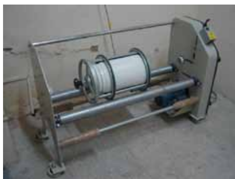
Figura 2. Moinho de bolas utilizado para preparar a barbotina
