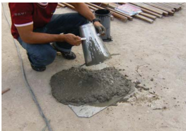
Figura 04 – A, B e C - Realização de Slump Test na obra C Fonte: equipe de pesquisa.
