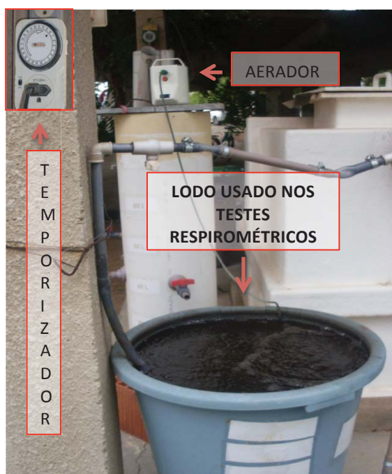
Figura 1: Esquema ilustrativo da configuração do sistema e da disposição dos seus elementos-suporte
