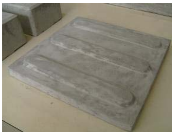
Figura 4. Ladrilho para deficientes visuais confeccionada com o resíduo do granito.
