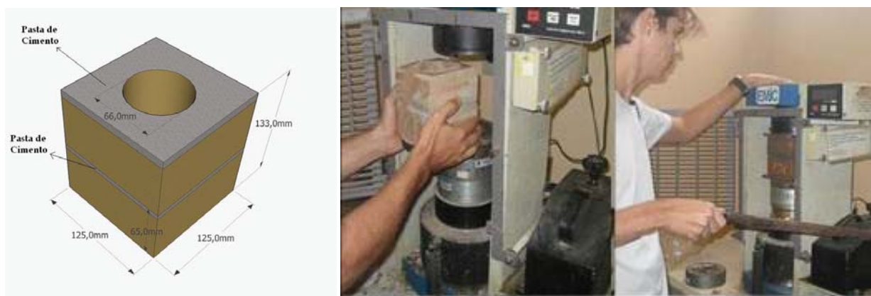
Figura 4 – Dimensões do corpo-de-prova e ensaio de resistência à compressão.
