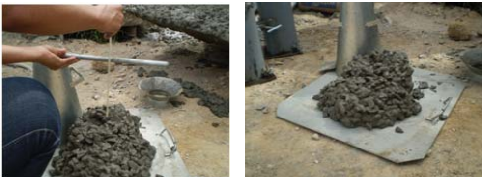
Figuras 07 – A e B - Ensaio de Slump Test na obra modelo Fonte: equipe de pesquisa
