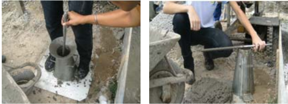
Figura 05 – A e B - Realização de Slump Test na obra B Fonte: equipe de pesquisa
