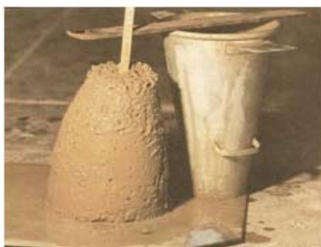
Figura 08- Slump de um concreto com bom teor de argamassa (HELENE & TERZIAN, 1992).
