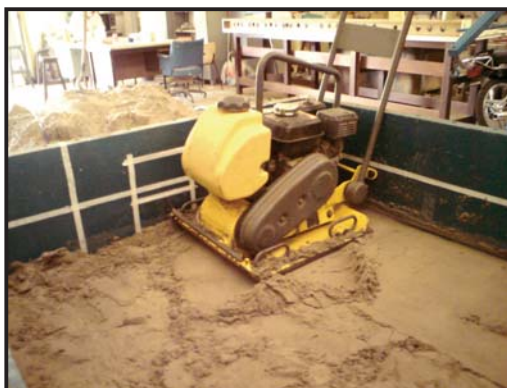
Figura 3: compactação do solo na caixa.
