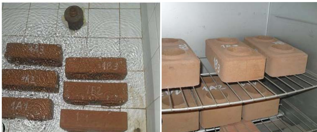
Figura 5 – Imersão e secagem dos tijolos para determinação da absorção de água.
