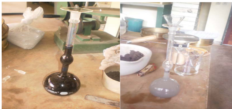
Foto 4 - Ensaio de determinação da massa unitária
