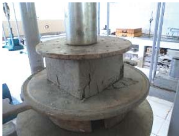
Figura 6. Detalhe do corpo de prova se rompendo.
