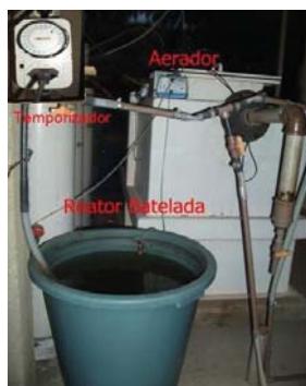
Figura 1: Reator batelada com aerador e temporizador acoplado.
