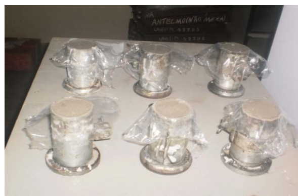
Foto 6- Moldagem dos CP's de argamassa.
