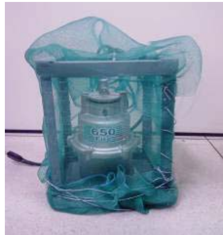
Figura 03- Bomba de sucção para alimentação dos sistemas e tela protetora.
