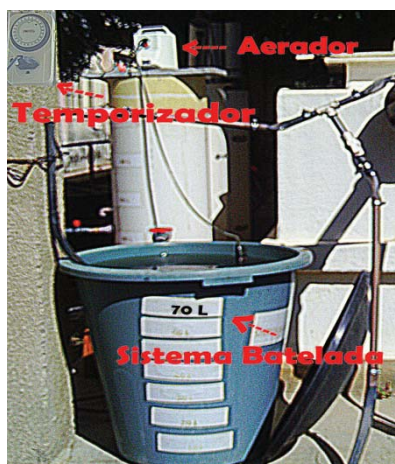
Figura 1 - Reator em Bateladas Seqüenciais (RBS) com temporizador e aerador.
