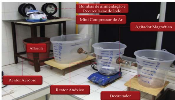
Figura 2a - Foto dos componentes do sistema e da configuração de montagem.
