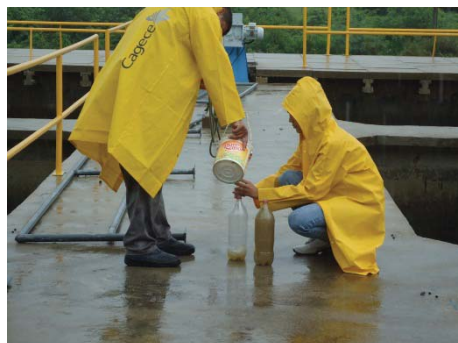
Figura 2: Lodo sendo coletado do filtro 16 da ETA-Gavião para análise físico-química. (janeiro/2010 - autor).
