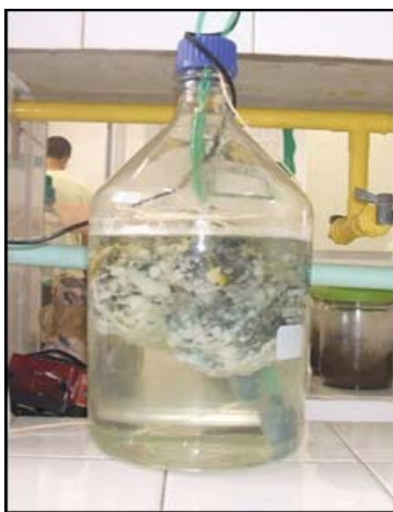
Figura 1: Reator em batelada sequencial com biomassa imobilizada de Aspergillus niger AN400.
