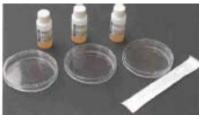
Figura 1 - Kit Coliscan Easygel de análise bacteriológica.
