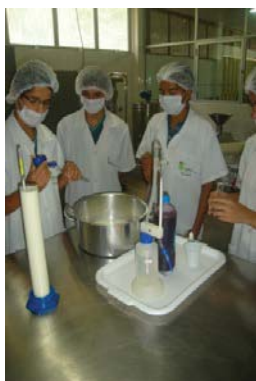
Figura 1 – Determinação da acidez °Dornic
