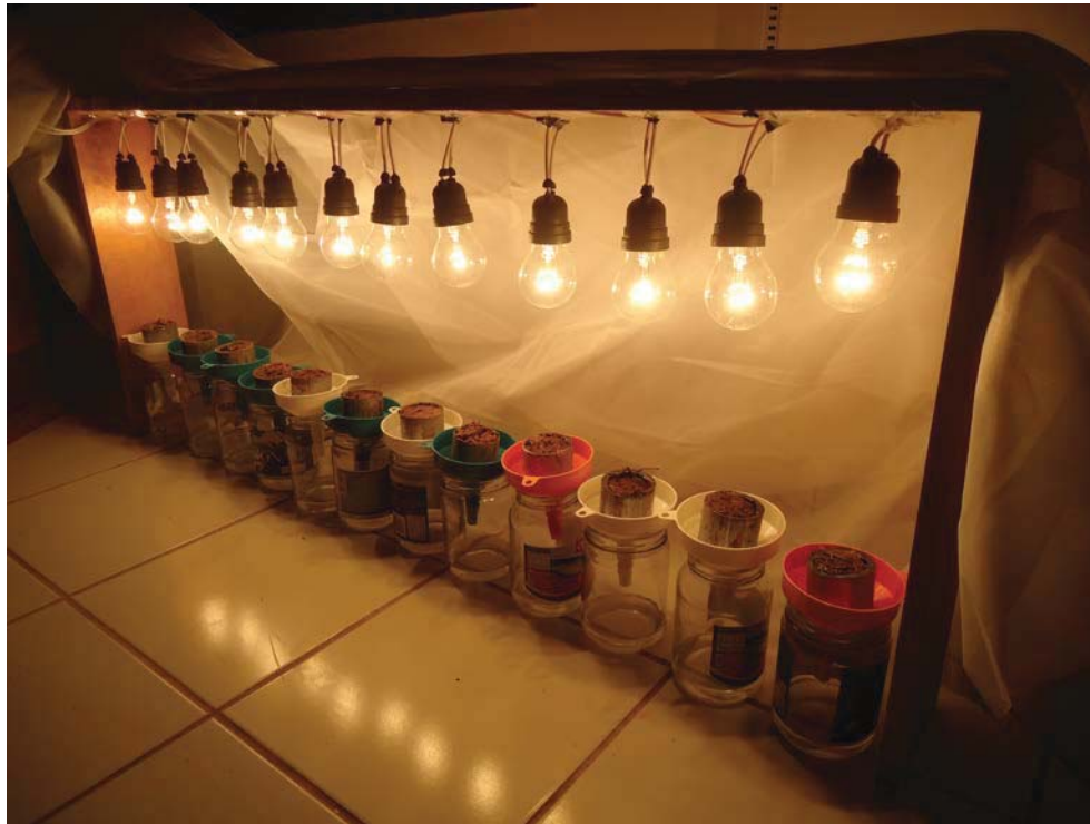
Figura 1. Equipamento de Berlese-Tüllgren modificado utilizado para extração da mesofauna edáfica.
