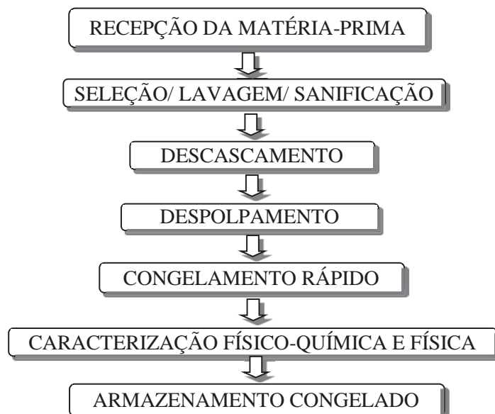
Figura 1. Fluxograma de processamento da polpa da manga Keitt
