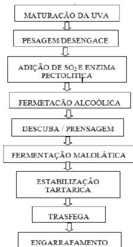
Figura 1 – Fluxograma de elaboração de vinho tinto método clássico (Peynaud, 1997).
