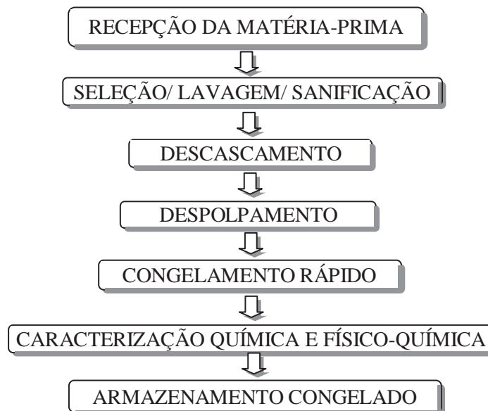
Figura 1. Fluxograma de processamento de polpa de abacaxi smooth cayenne.
