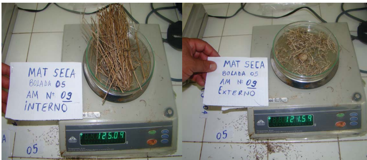
Figura 2: PEREIRA, F. C.; & VERAS, R. P.; Pesagem em balança de precisão, Matéria Seca
