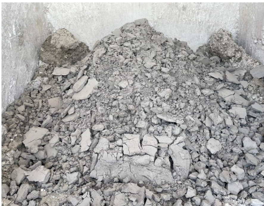
Figura 6 – RPRO no galpão da empresa Thor Mármore e Granitos LTDA.
