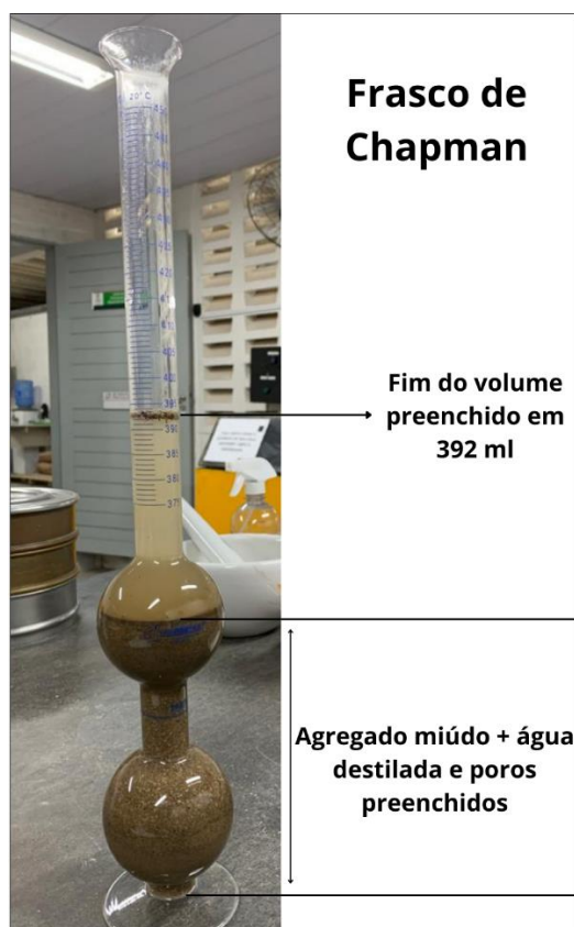
Figura 13 – Ensaio de massa específica do agregado miúdo.
