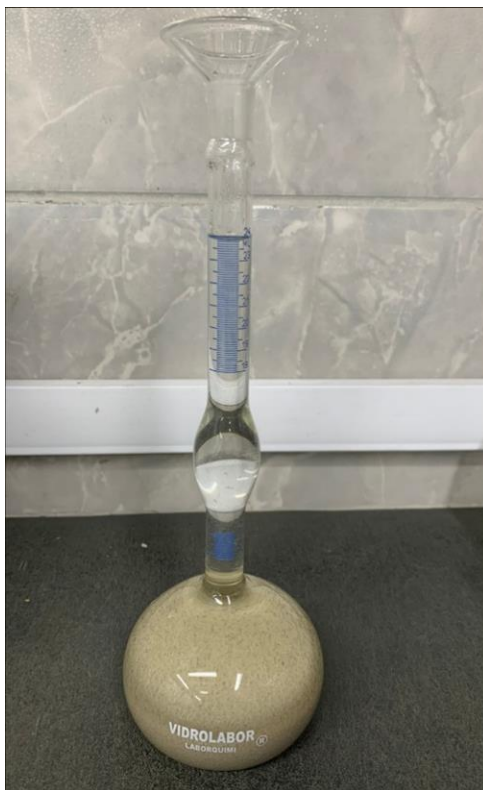
Figura 8 – Ensaio de massa específica no frasco de Le Chatelier do RPRO.
