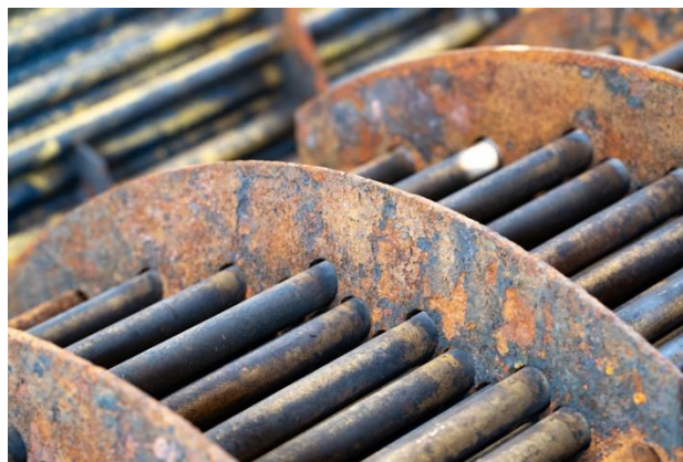
Figura 12: Formação de fouling [1].
