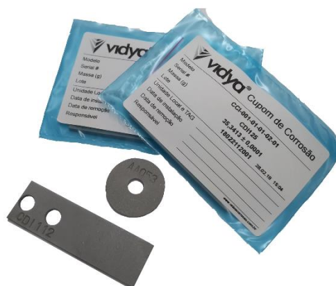
Figura 16: Cupons de corrosão.
