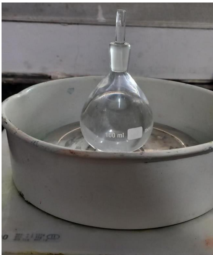
Figura 11 - Picnômetro da Marca Dorvil Utilizado para Realização da Análises de Densidade dos Fluidos
