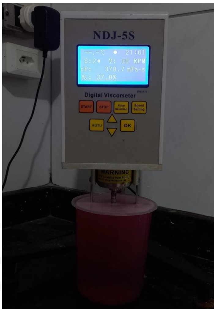
Figura 12 - Análise da Viscosidade do detergente utilizando um Viscosímetro de Brookfield
