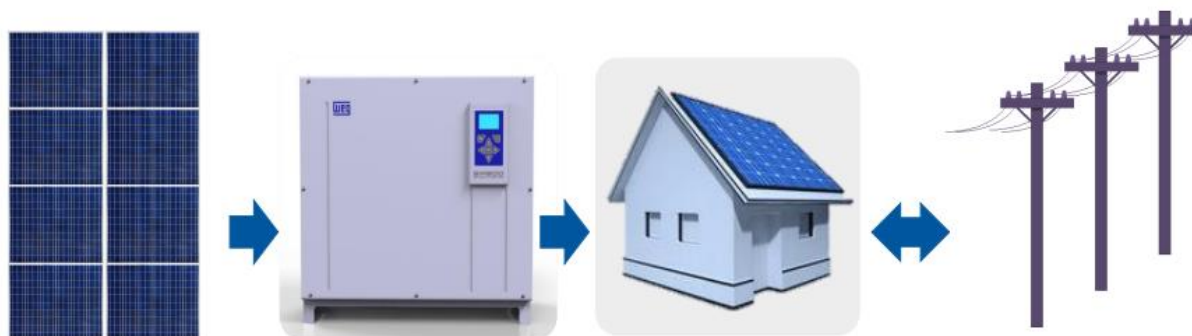
Figura 2: Sistema conectado à rede elétrica.
