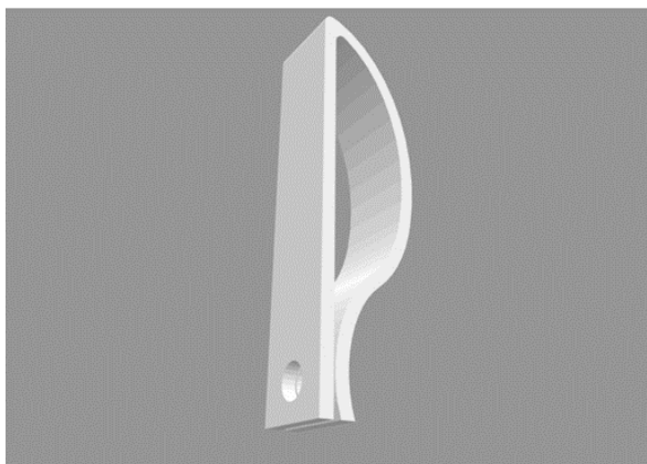
Figura 2 - Modelo esquemático de microscópio produzido por impressora 3D em estrutura fixa.
