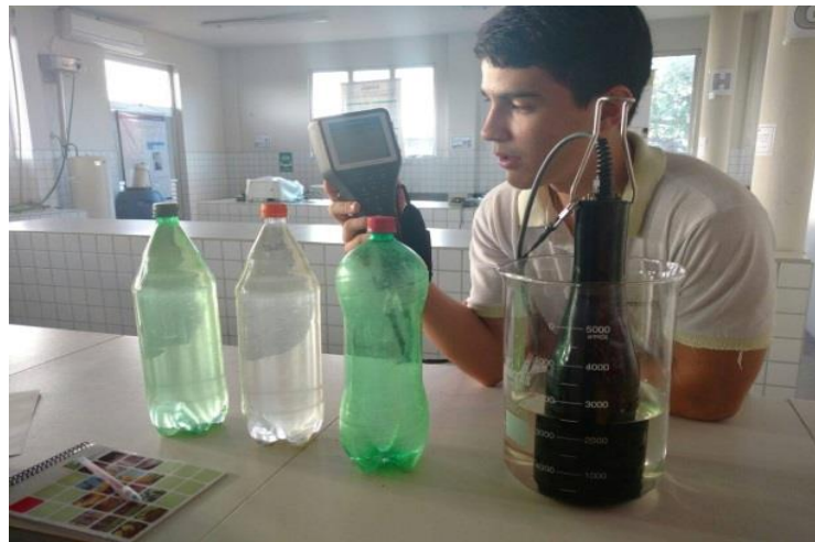
Figura 2 – Amostras armazenadas em garrafas Pets à esquerda e sonda multiparamétrica de qualidade de água à direita.
