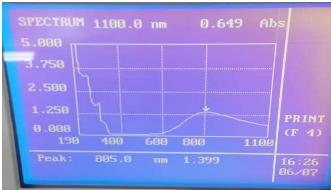
Fotografia 3 – Espectro de absorção para a solução aquosa de \text{Cu}(\text{NO}_3)_2 \cdot 3\text{H}_2\text{O} obtido de 190 a 1100 nm.
