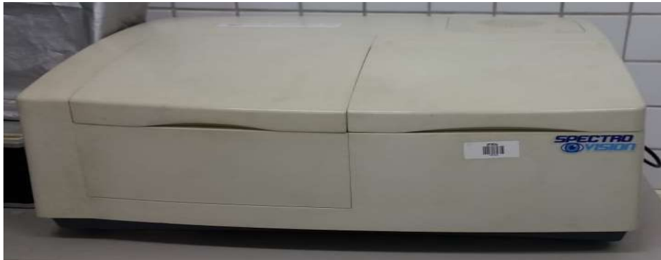
Fotografia 1 – Espectrofotômetro UV-VIS Spectro Vision.
