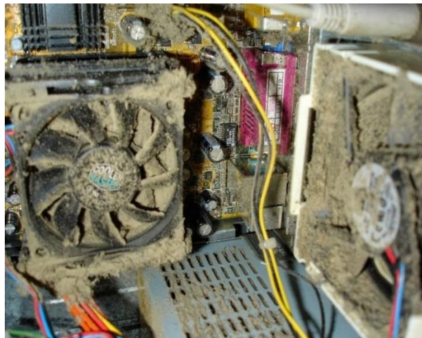
Figura 2: Gabinete com placa mãe, cooler e dissipador de calor antes da limpeza.
