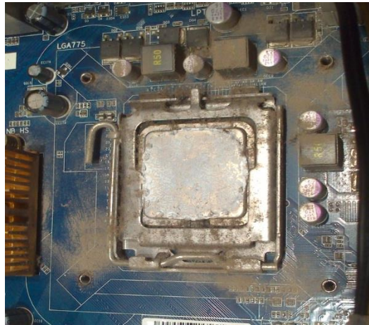
Figura 1: Processador antes da limpeza e troca de pasta térmica.
