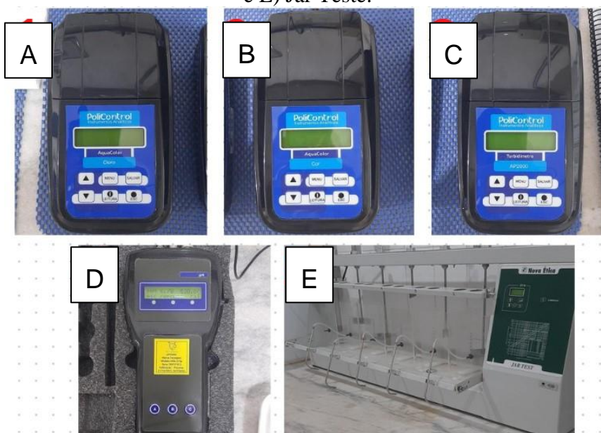
Figura 21 – A) Leitor de cloro; B) Fotocolorímetro; C) Turbidímetro; D) pHmetro; e E) Jar Teste.
