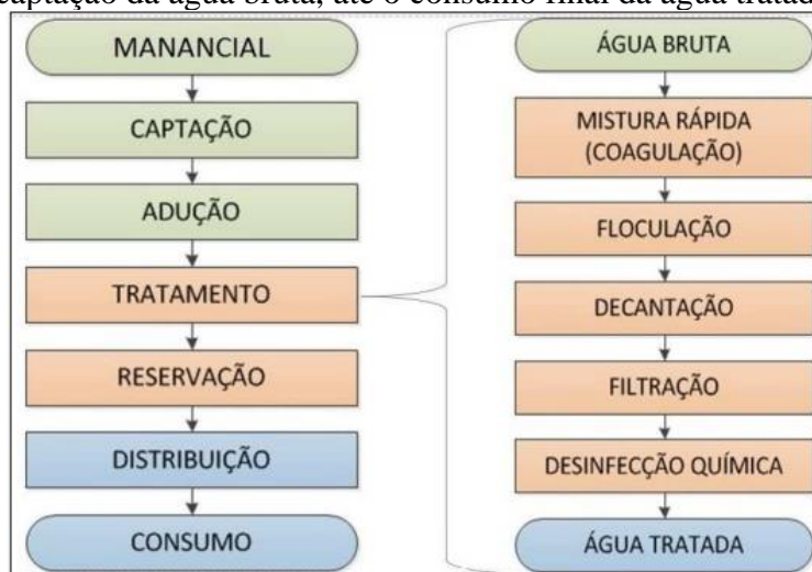
Figura 07 – Fluxograma mostrando o processo geral realizado pela ETA Extremoz, desde a captação da água bruta, até o consumo final da água tratada.
