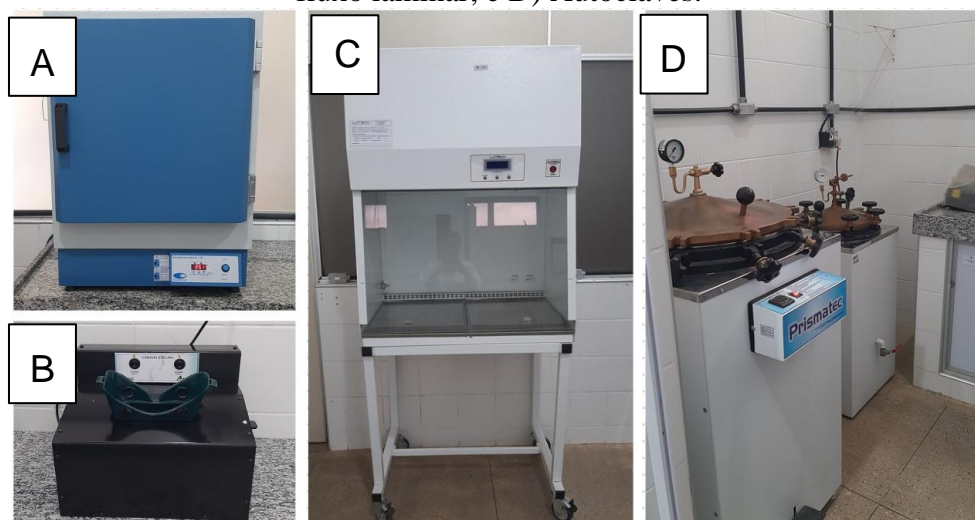
Figura 23 – A) Estufa bacteriológica; B) Câmara escura de luz ultravioleta; C) Cabine de fluxo laminar; e D) Autoclaves.
