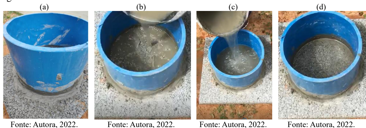
Figura 15 - Análise das Placas e Concreto Permeável - PLCP.
