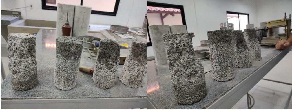
Figura 28 - Tipos de Rupturas dos CP's ensaiados
