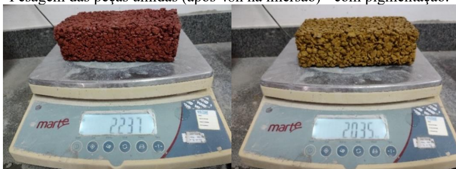
Figura 22 - Pesagem das peças úmidas (após 48h na imersão) - com pigmentação.
