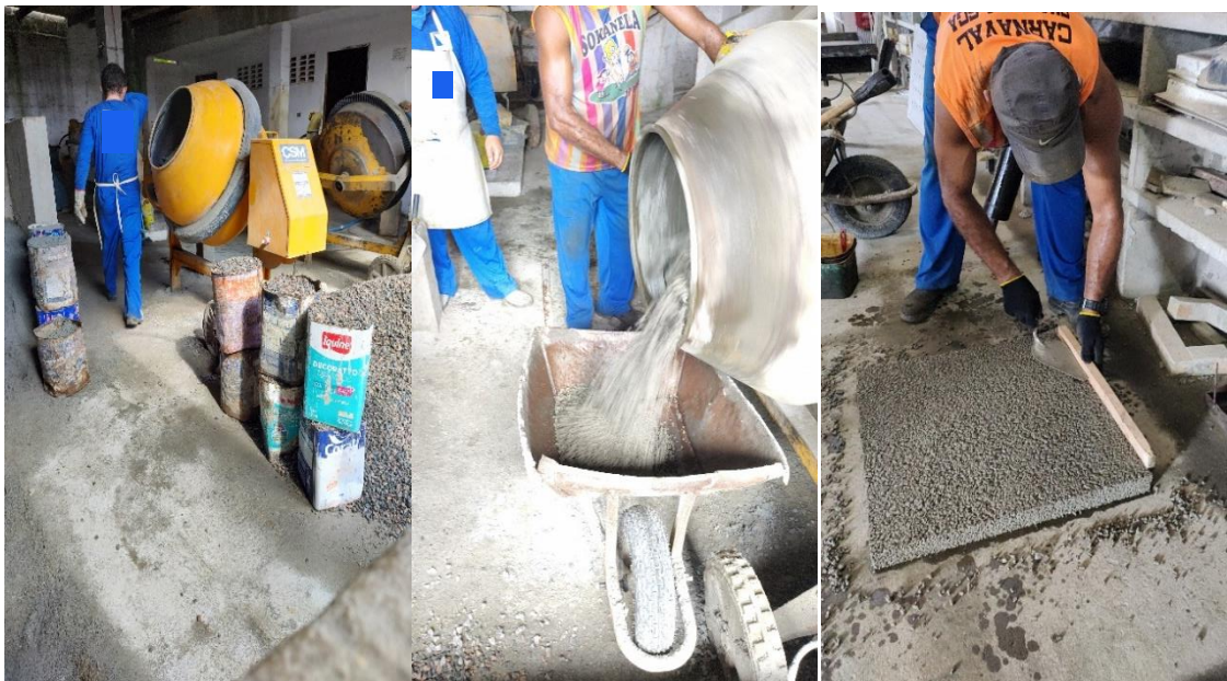
Figura 32 - Demonstração de mistura do traço e moldagem das peças, durante o processo de fabricação.
