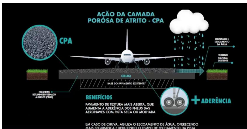
Figura 4 - Características CPA em Pistas de Pouso e Decolagem no Brasil
