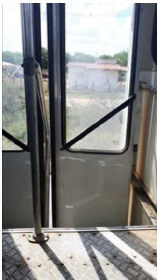
FIGURA 5 – PORTA QUE NÃO FECHA TOTALMENTE
