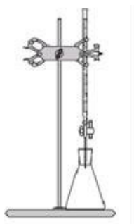
Figura 12.6: Bureta acoplada ao erlenmeyer para a determinação da tensão superficial pelo peso da gota (BEHRING, 2004)
