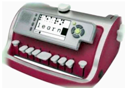
Figura 12: Máquina de escrever Braille com retorno sonoro e visual.
